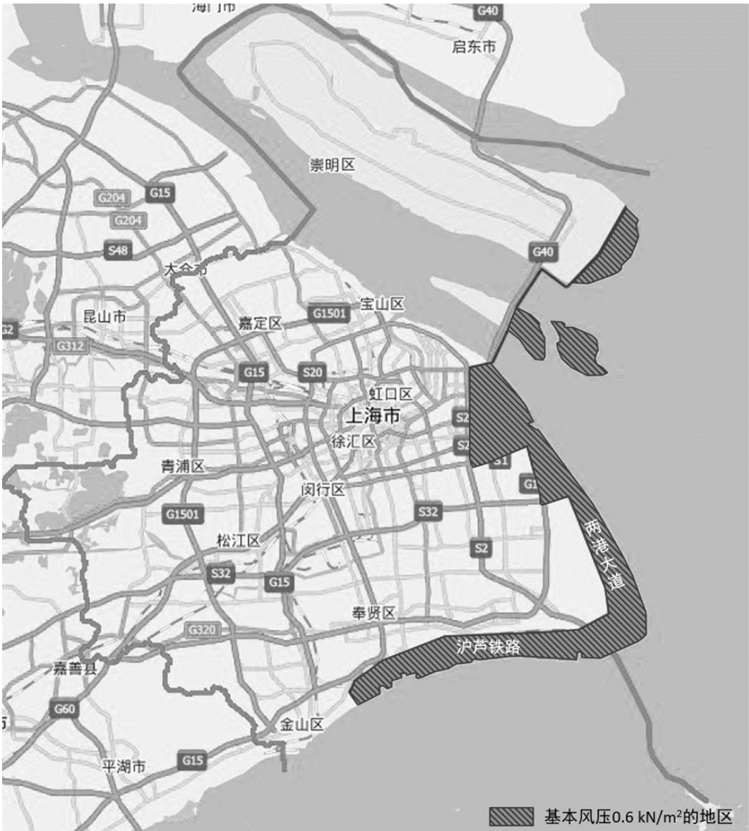
图B.1 户外招牌结构设计基本风压分布图
